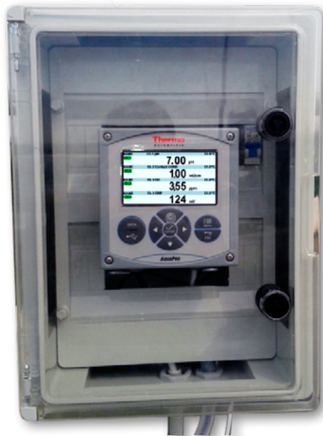
Фиг. 2 Измерване на основни показатели в реално време с контролер “AquaPro Thermo Scientific”.
